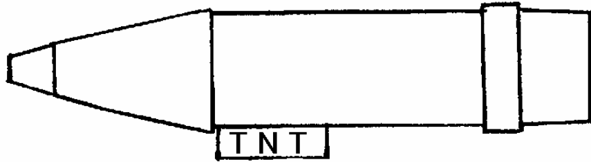
รูปที่ ง-5 การวางดินระเบิดสำหรับกระสุนชนิดควันทันฟอสฟอรัส (WP, PWP)
